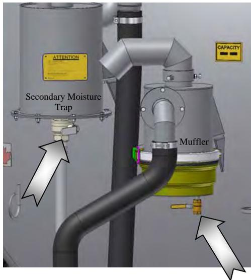
**FIG. 4 DRAIN VALVE**
