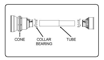
FIG. 6 DRIVELINE SHIELD
