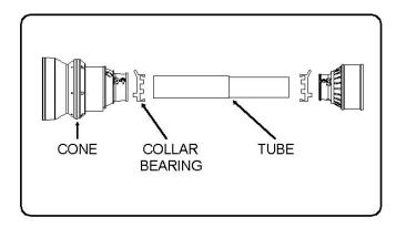
FIG. 7 DRIVELINE SHIELD
