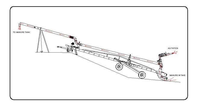
FIG. 1 PRINCIPLES OF OPERATION
